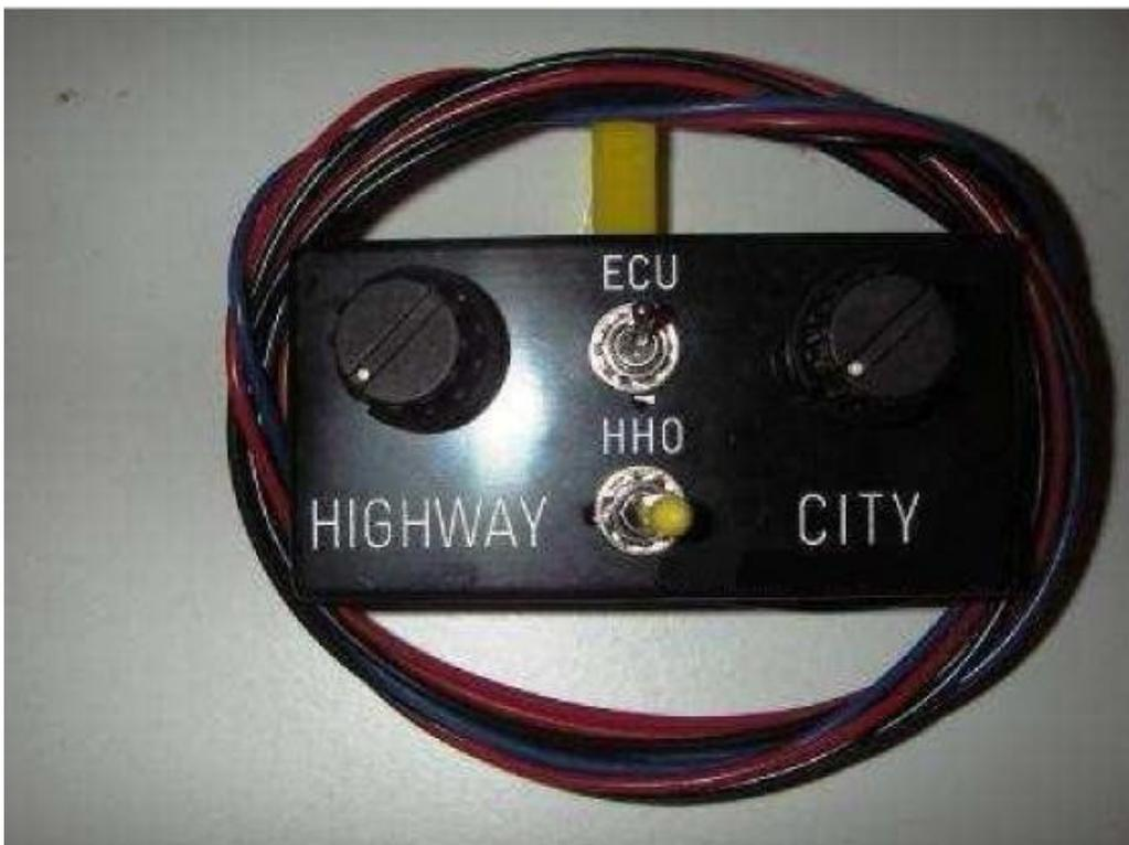
**DENKEN SIE DARAN:** die regelbaren Widerstände sind so konstruiert, dass sie, wenn Sie den Knopf im Uhrzeigersinn drehen die Mixtur **magerer** machen und wenn Sie den Knopf entgegen dem Uhrzeigersinn drehen wird die Mixtur **fetter**.
