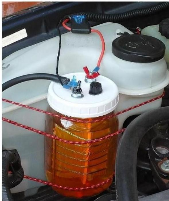
*Dieses Bild zeigt den Einbau in einem Nissan – der gezeigte Elektrolyseur hat jedoch nur eine HHO Leitung, und das Überdruckausgleichsventil fehlt.*
